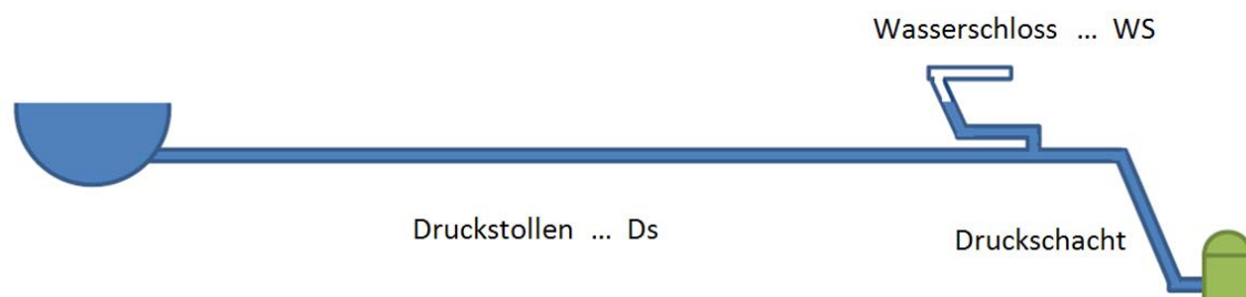
Abb. 4.1.1 Schema System Triebwasserweg mit Wasserschloss
