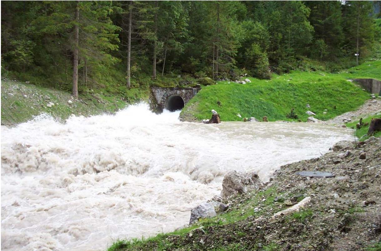
Abbildung 13: Überprüfung des Grundablasses ( $Q = 15 \text{ m}^3/\text{s}$ , Blick auf den Stollen-
