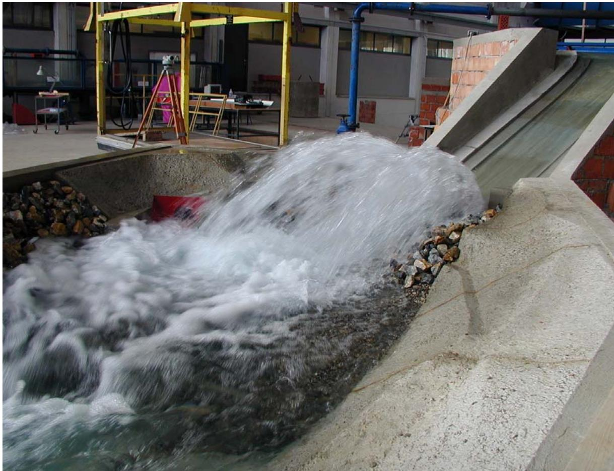
Abbildung 9: Variante Sprungchance im Modellversuch bei  $Q = 70 \text{ m}^3/\text{s}$
