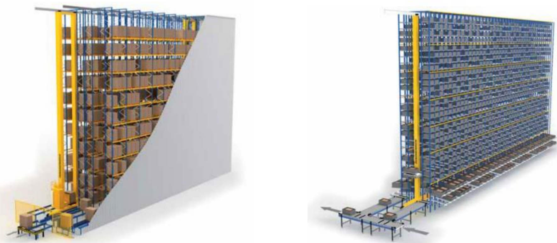
Abb. 1: Hochregallager, Automatisches Kleinteilelager
