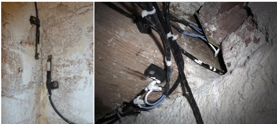
Abb. 7 Kombinierte Luftfeuchte-/Temperatur-Flächensensoren ID vor der Montage des Dämmsystems, hier in der Gebäude-Außenkante im Zellulosefeld
