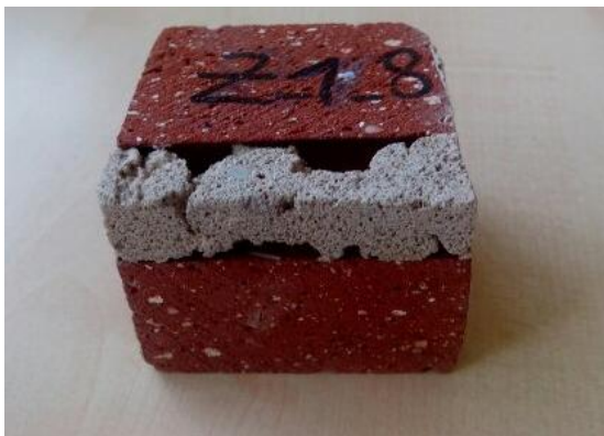
Abb. 102 Mauerwerksausschnitt mit nur teilweise aufgefüllter Mörtelfuge
