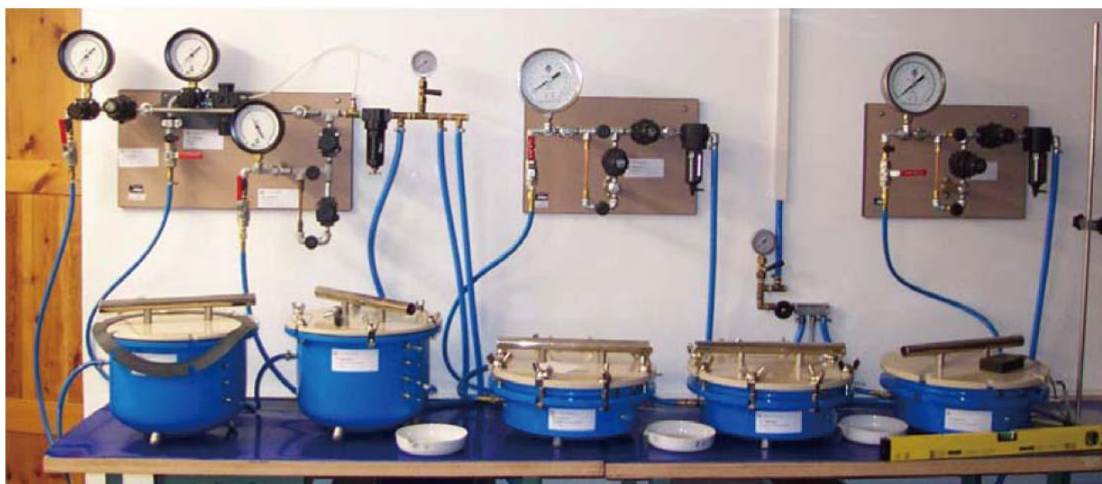
Abb. 35 Druckplattenapparaturen zur Bestimmung der Wasserretention von kapillarporösen Baustoffen
