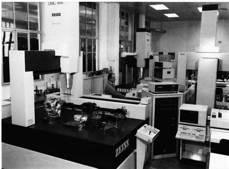
*Salle des mesures avec centrales de mesure 3D destinées à la coordination de la fabrication mécanique des éléments du moteur et de l'engrenage.*
