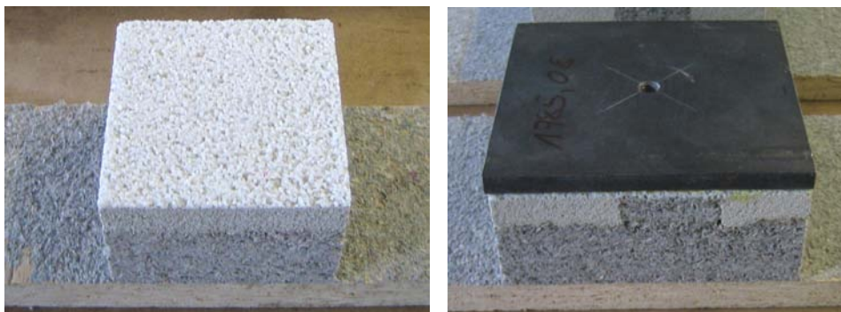
Fig. 7 Verbundsystem-Probekörper ohne und mit aufgeklebter Stahlplatte
