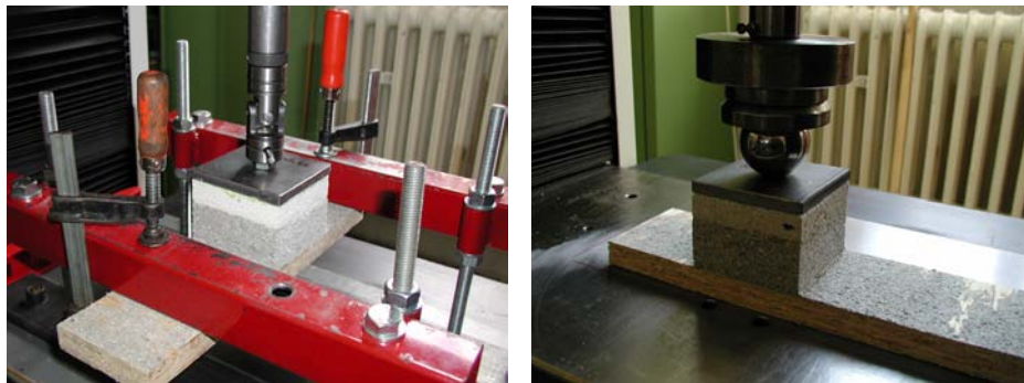
Fig. 8 Prüfvorrichtung Zugfestigkeit normal zur Probenebene nach ÖNORM EN 1607 und Druckfestigkeit nach ÖNORM EN 826
