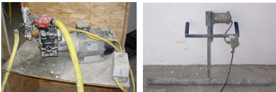
Fig. 6 Förderpumpe und Abzugsbürste
