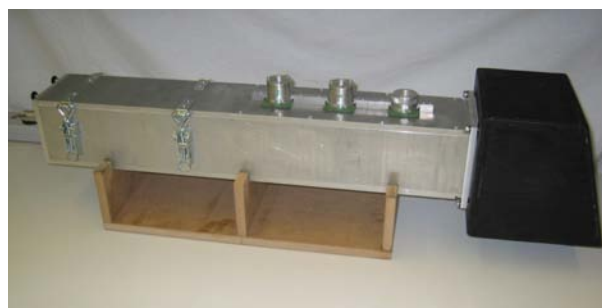
Fig. 26 Schematische Skizze der Messanordnung und Impedanzrohr 10 x 10 cm (hier ohne Messmikrofone)
