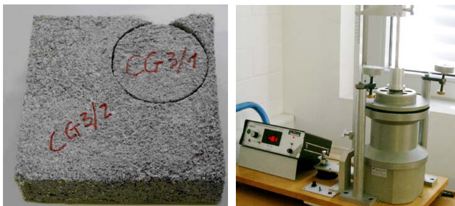
Fig. 29 Probenvorbereitung und Messung des Strömungswiderstandes nach DIN EN 29053 (1993)
