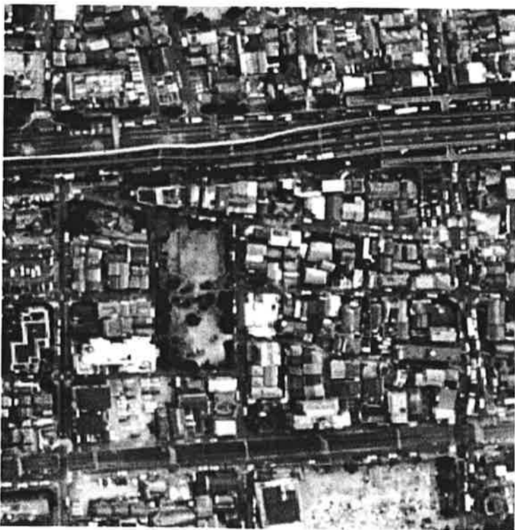
Abb. 1: Vergleich der Aussagekraft von 1 m und 10 m Pixeln anhand eines simulierten Datensatzes aus Luftbildern der Erdbebenschäden 1995 in Kobe/Japan. (Space Imaging, 1995).
