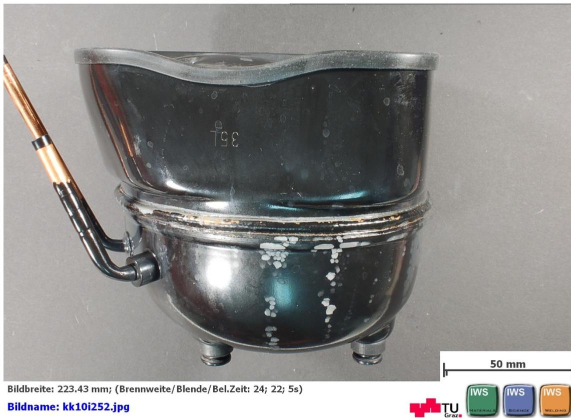
Abbildung 24 Seitenansicht Probe III nach 48 Stunden AHT
