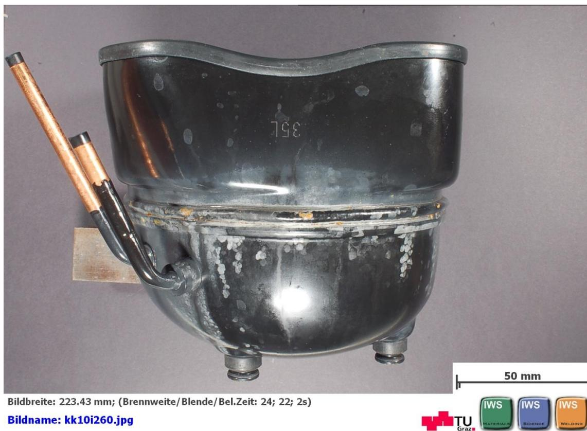
Abbildung 32 Seitenansicht Probe I nach 120 Stunden
