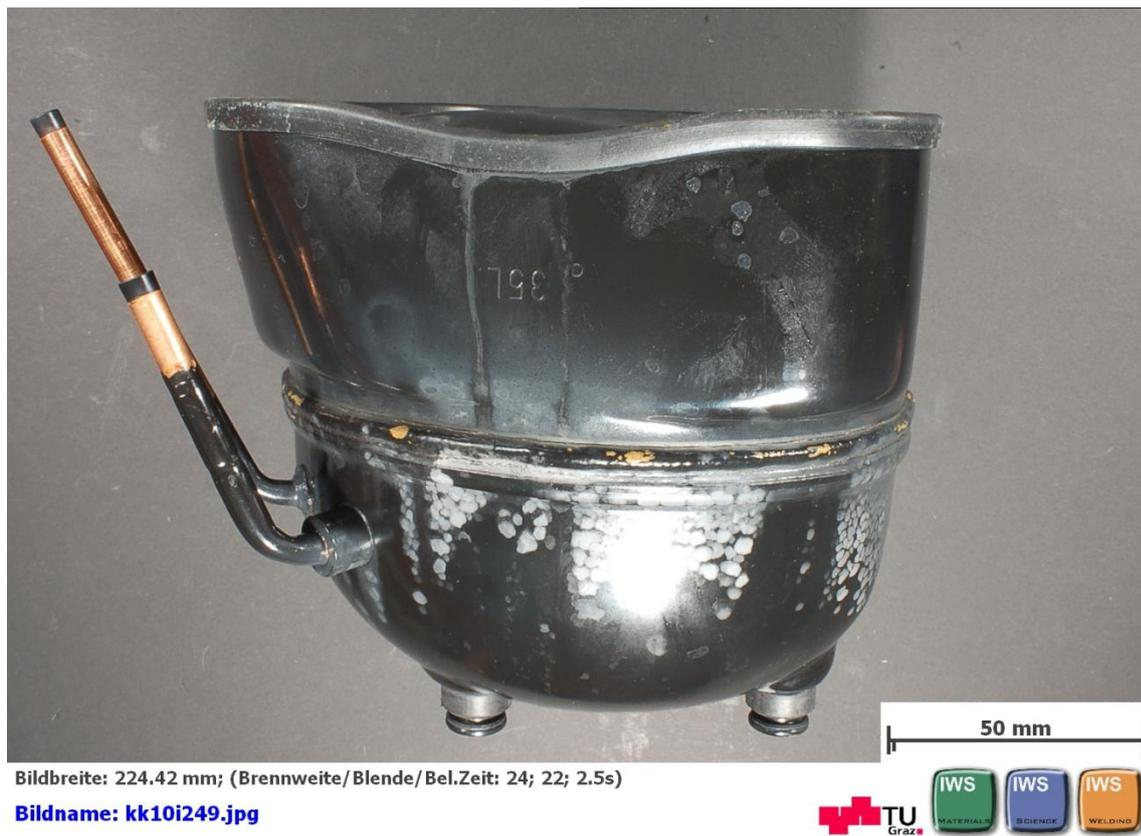
Abbildung 22 Seitenansicht Probe II nach 48 Stunden AHT
