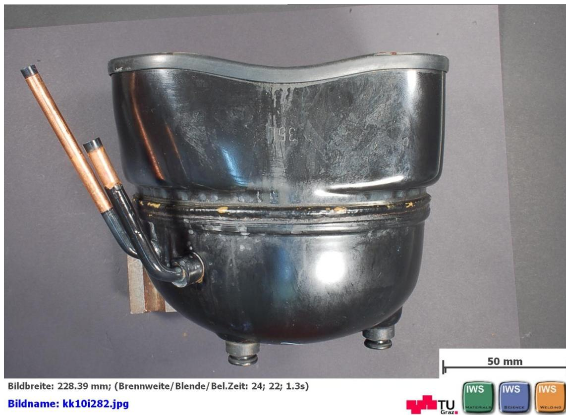
Abbildung 46 Seitenansicht Probe II nach 240 Stunden AHT
