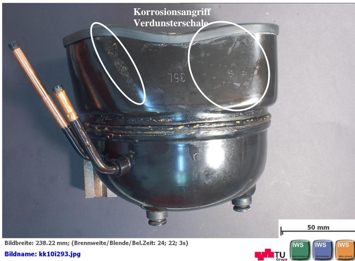
Abbildung 40 Seitenansicht Probe 2 nach 240 Stunden AHT
