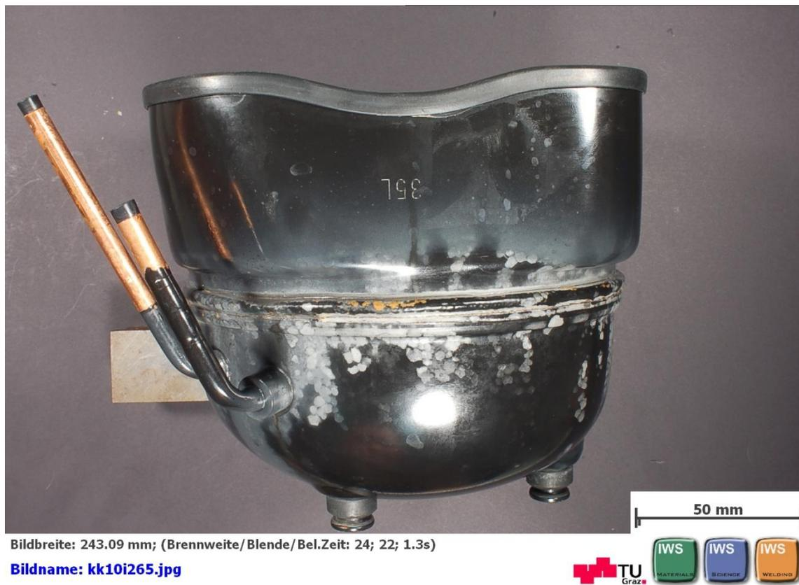
Abbildung 36 Seitenansicht Probe III nach 120 Stunden AHT
