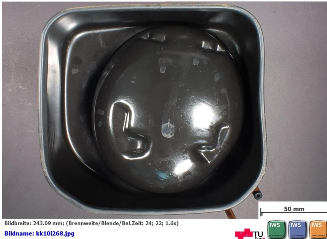
Abbildung 25 Draufsicht Probe 1 nach 120 Stunden AHT
