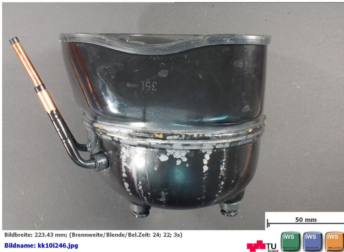
Abbildung 20 Seitenansicht Probe I nach 48 Stunden AHT
