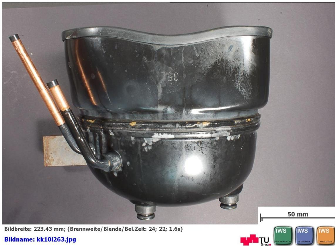
Abbildung 34 Seitenansicht Probe II nach 120 Stunden AHT
