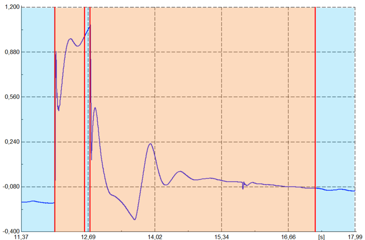
Abbildung 3: Einteilung in transiente (orange) und stationäre (blau) Zeitbereiche am Beispiel einer Blindleistungsmessung
