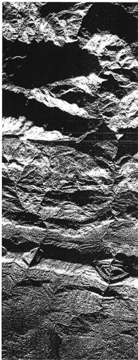
Abb. 1. Ausschnitt einer Radarbildkarte (links) und des entsprechenden Höhenmodells mit 50-m-Kurven, welche aus etwa 14 Radarbildern mittels eines Stereo-Auswerteverfahrens erstellt wurden. Maßstab der Karte 1:50 000; Pixelgröße 6 m. Dargestellter Ausschnitt mit 45 km × 18 km (Vexcel Corp. im Auftrag der Firma Intera unter Verwendung von Star-1-Radarbildern)
