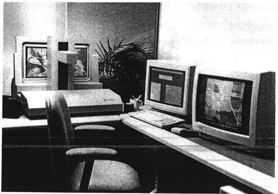
Abb. 2. Bildgestütztes Geographisches Informationssystem zur Erstellung eines gemeindefreien gr: Datensystems der versiegelten Flächen der Stadt Denver (540 Katasterkarten, 165 000 Grund 600 000 „Lots“, 1200 Luftbilder). Das System wurde 1989 von der Firma Vexcel geliefert, die Aus aller 165 000 Grundstücke wird durch Stadtbeamte in einer Dreijahresperiode abgewickelt (1989
