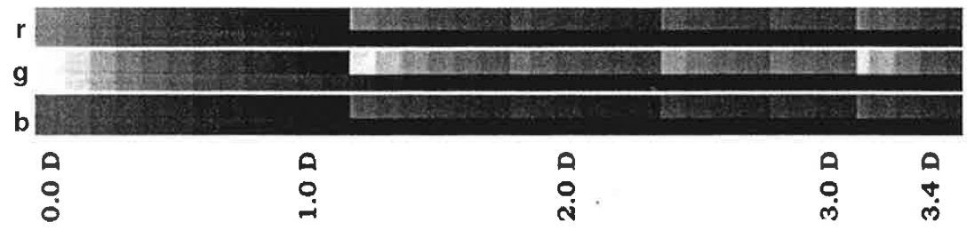
Abb. 7: Abtasten eines Graukeiles mit einem Dichteumfang von 3.4 D und Wiedergabe der Intensitätswerte der drei Farbzeilen. Zur Darstellung wurde der Dichteumfang in 6 getrennte Zonen geteilt und radiometrisch gespreizt.
