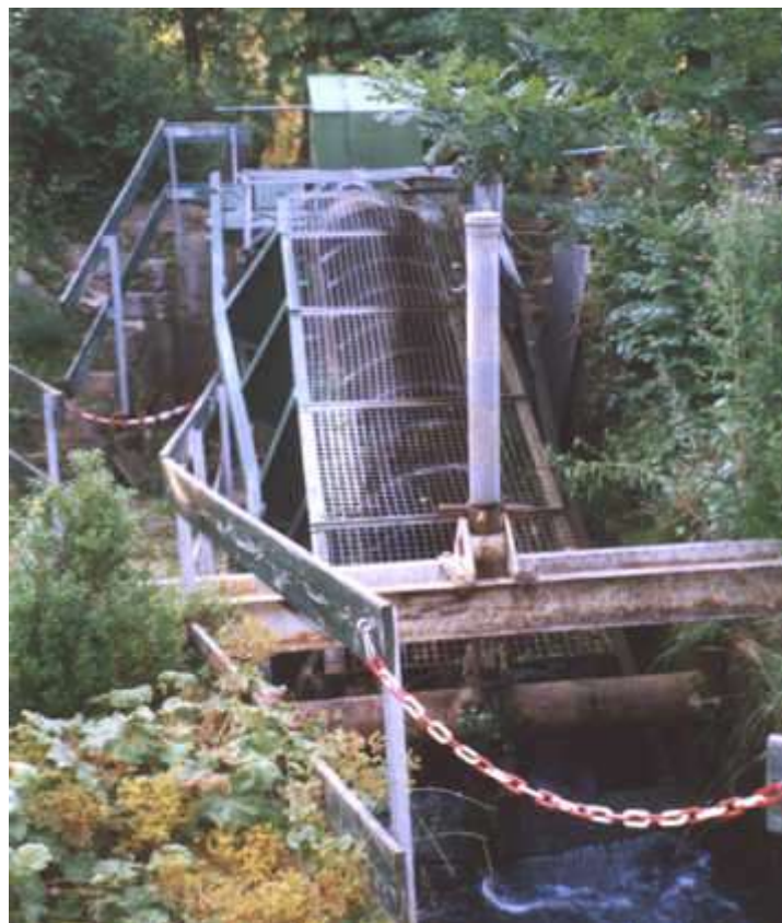
Figure 9: World's first hydrodynamic screw, situated at Obere Schlägweidmühle. (Förderverein Wind- und Wasserkraft Ostalb e.V.)
